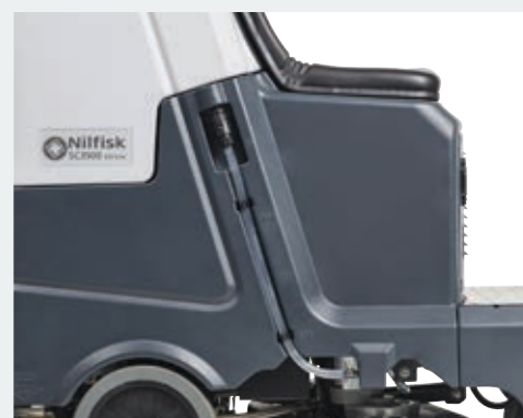
Semplice monitoraggio manuale del livello dell'acqua nel serbatoio
