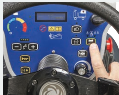
La testata spazzole/tergipavimento si abbassa automaticamente, minimizzando lo sforzo dell'operatore
